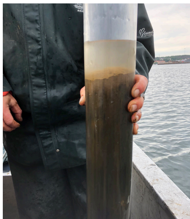
Sedimentprovtagningen utfördes mestadels med plexiglasrör och sk Kajak-provtagare.
